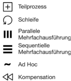
Abb. 3.38 Modifikatoren zur Abbildung unterschiedlichen Ausführungsverhaltens
