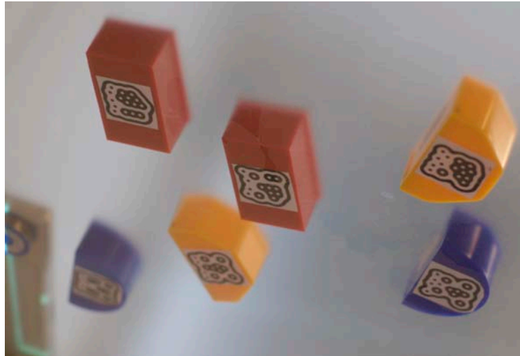
Abbildung 7.8.: An Tokens angebrachte ReactIVision-Codes zur Identifikation
